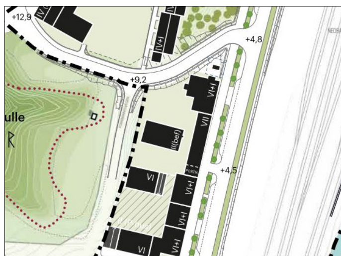
Utsnitt ur illustrationsplan. I detaljplanen ges kvarvarande del av verkstadsbyggnaden inom Runby 1:9 skydd i plan och integreras i den nya bebyggelsen. Ladbrovägen har förskjutits för att ta hänsyn till det utökade spårområdet för Ostkustbanan.
